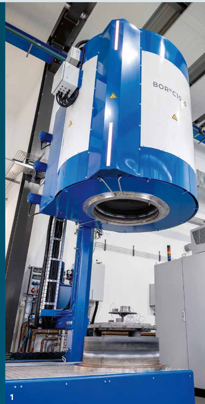
Die neue Gasborieranlage am Fraunhofer IST erzeugt durch Diffusionsbehandlungen bei bis zu 1050°C boridische Randzonen mit außergewöhnlichen technologischen Eigenschaften.
