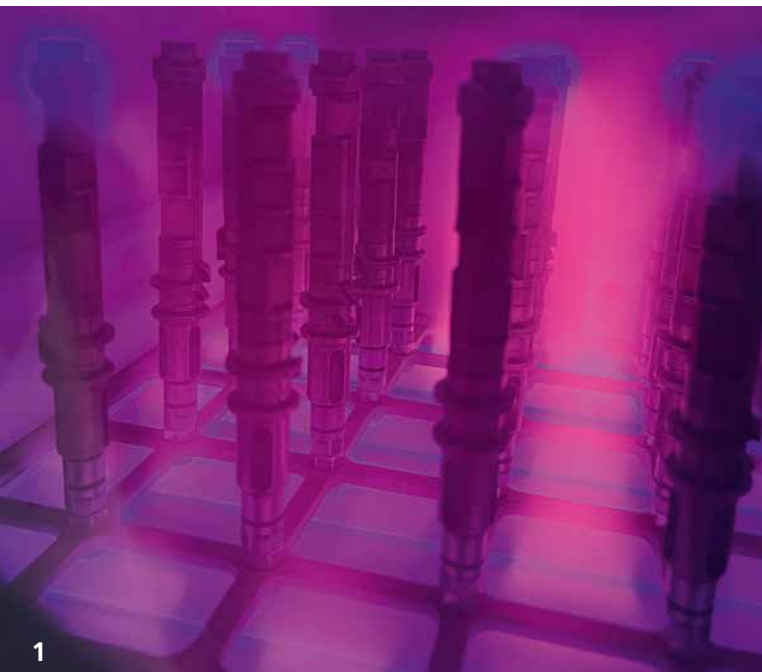
Komponenten für hochpräzise Fahrradgetriebe werden mittels COAD®-Prozess im Plasma beschichtet.
