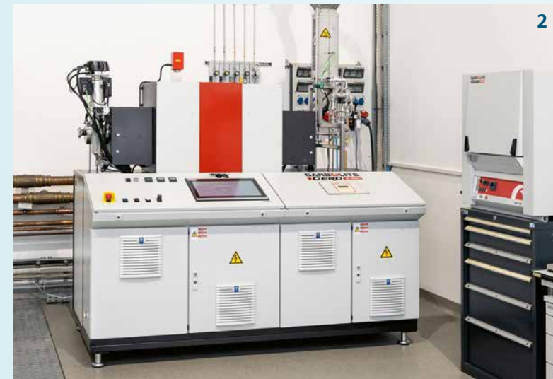
Der seit neuestem verfügbare Hochtemperaturofen erlaubt Untersuchungen im Temperaturbereich von bis 1600 °C.
