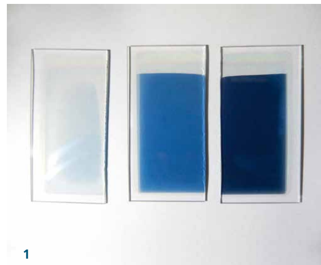
1 Wolframoxid-Schicht mit zunehmender Interkalation von Lithium-Ionen (15 bis 39,5 mC/cm 2 , von links nach rechts).
