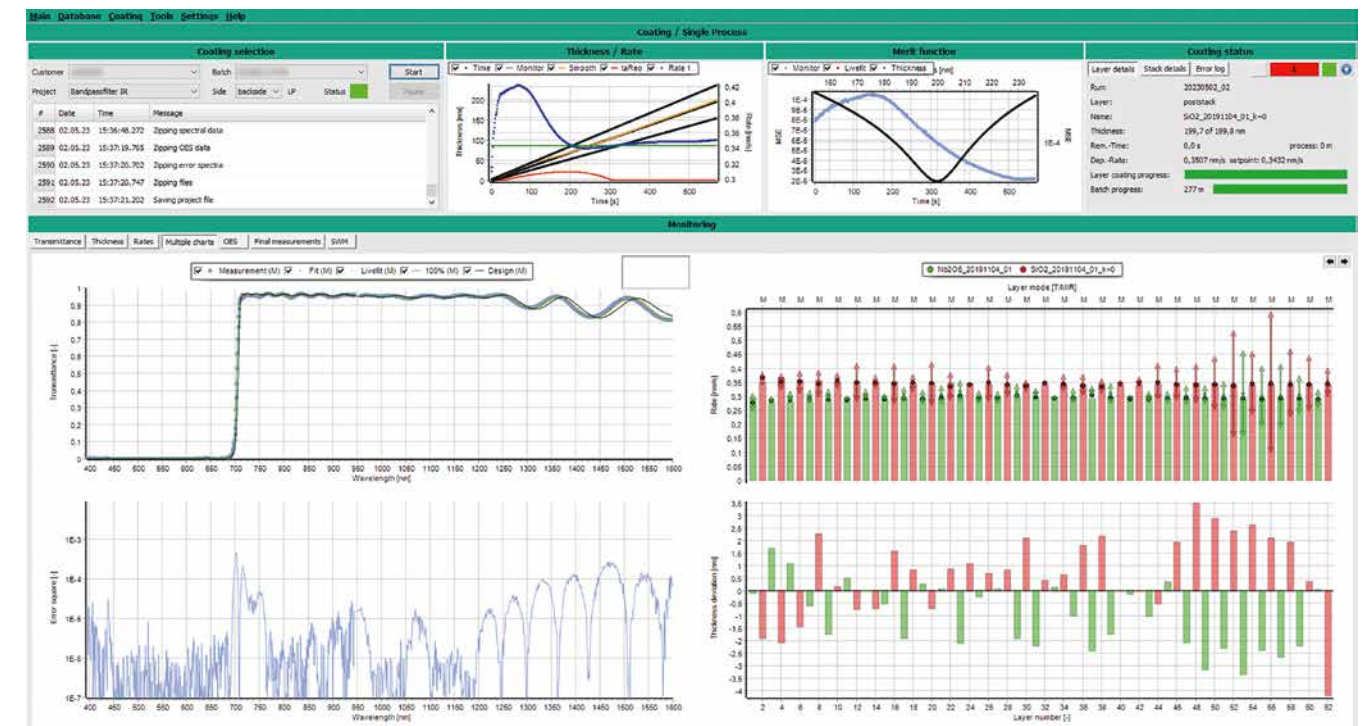
Prozesskontrolle auf Industrieanlage: Benutzeroberfläche von MOCCA® während der Beschichtung eines Kavitätenfilters.
