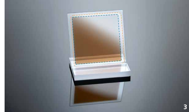
3 Erster Prototyp eines elektrochromen Emittanz-Modulators; die gestrichelten Linien markieren die Lage der jeweiligen Kontaktschicht.
