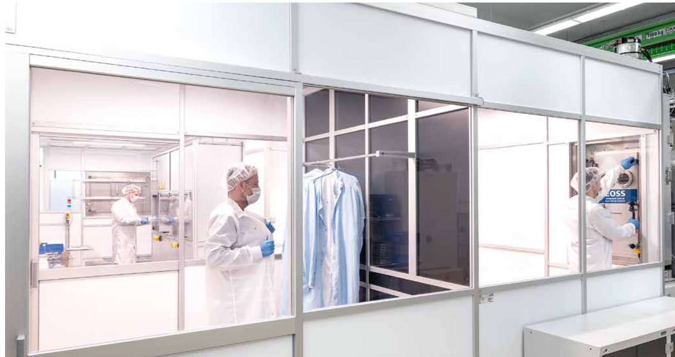
Reinraum zur Vorbereitung der Beschichtungsprozesse an der FHR.Star-EOSS® mit der EOSS®-Technologie des Fraunhofer IST der ersten Generation.
