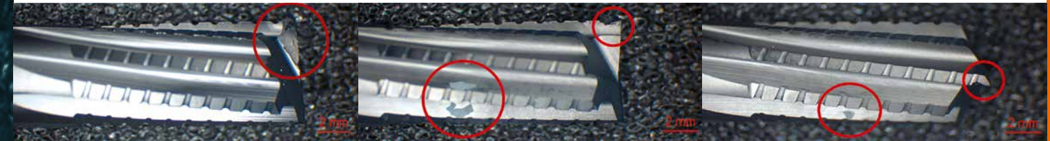
Beispiele verschiedener Defekte an beschichteten Werkzeugen: Ausbrüche unterschiedlicher Größe an Grundkörper und Schneide (alle drei Werkzeuge) und Schichtdelamination (mittleres bzw. rechtes Werkzeug).
