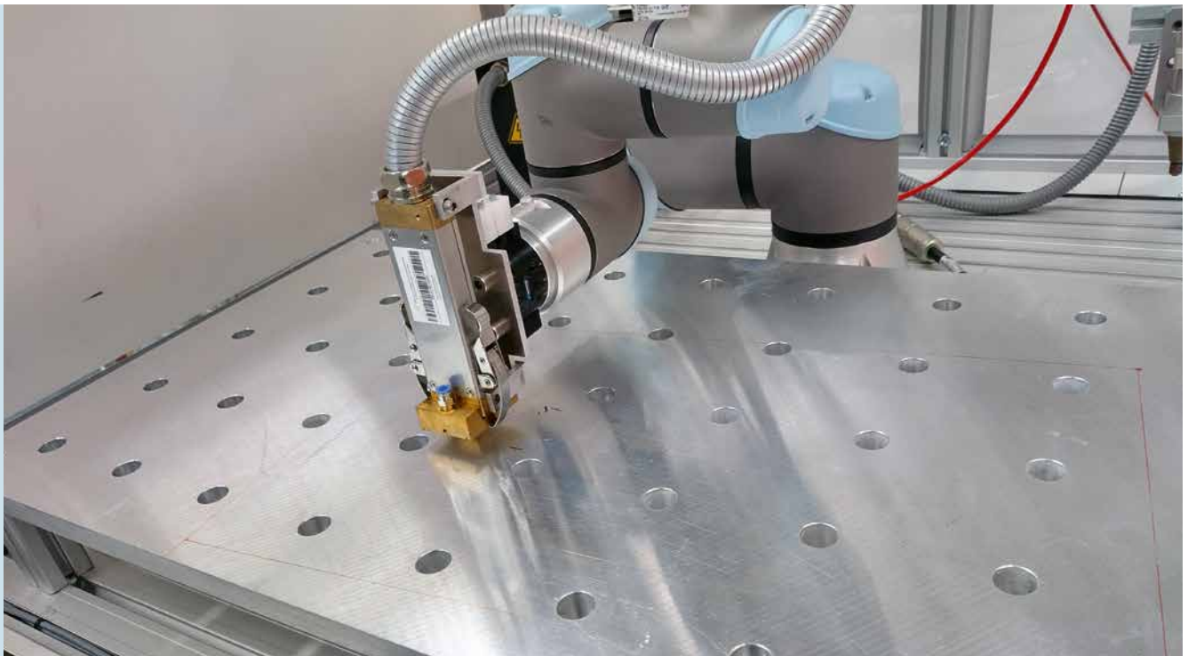
Atmosphärendruckplasma-Behandlungssystem für mittelgroße 3D-Bauteile (< 50 cm x 50 cm x 80 cm) mit robotergeführter Plasmadüse.
