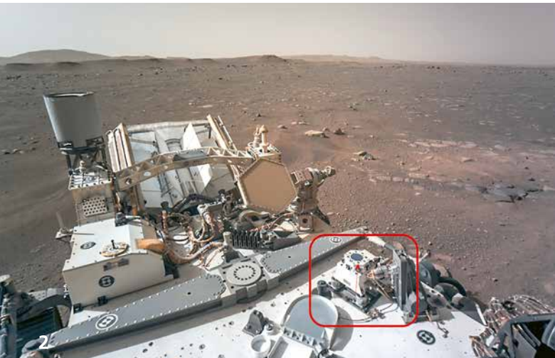
Technologie des Fraunhofer IST auf dem Mars: Der Interferenzfilter (rechts) ist Bestandteil eines optischen Sensors zur Staubcharakterisierung im »Mars Environmental Dynamics Analyzer«, kurz MEDA.
