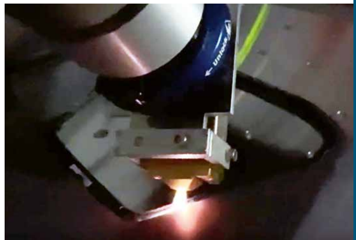
Plasmabehandlung von dreidimensionalen Oberflächen mit Hilfe eines robotergeführten Systems.
