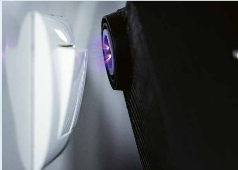
Modulare Plasmaquelle zur Reinigung und Desinfektion von Oberflächen.
