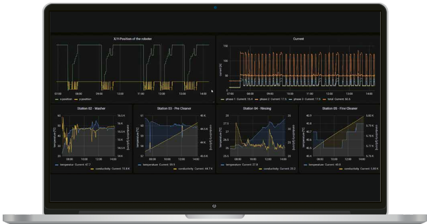
Dashboard-Ansicht der In-situ-Prozessdaten von der Reinigungsanlage am Fraunhofer IST.
