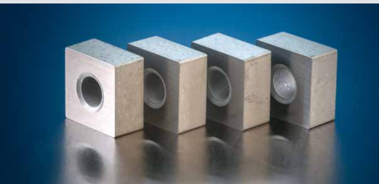
Wendeschneidplatten mit einfacher Werkzeuggeometrie für die Entwicklung von PVD-Hartstoff- und CVD-Diamantschichten.
