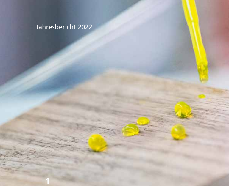
Schmutzabweisende Beschichtung auf einem Holzfurnier.
