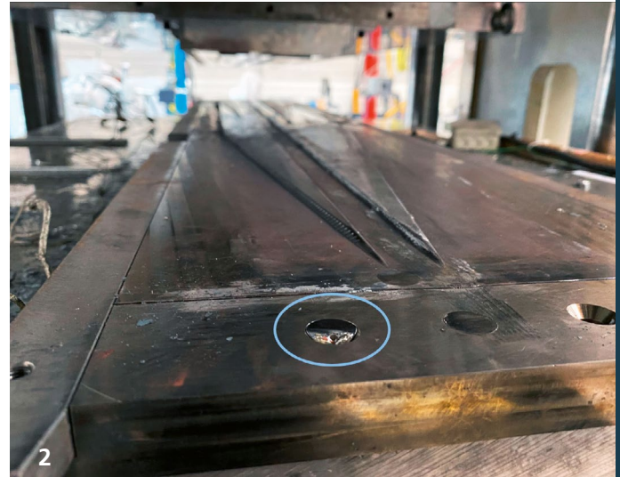
Flachbackenwerkzeug mit integriertem Sensoreinsatz. 1
