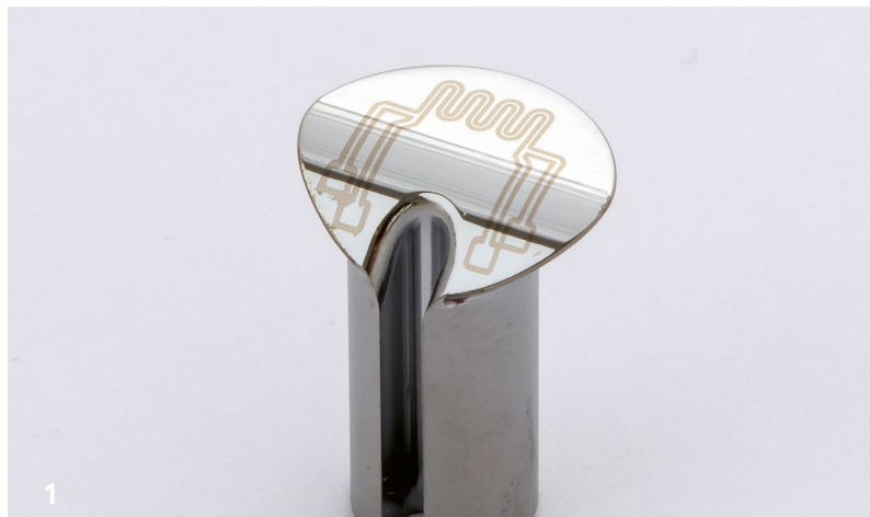
Mit Dünnschichtsensorik beschichteter Sensoreinsatz.
