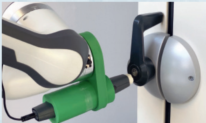
Automatisierte Reinigung mittels Plasmatechnologie: Integration einer Plasmaquelle in einen Roboterarm.
