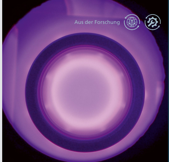
Behandlung eines Außenringturms mittels Niedertemperatur-Plasmanitrieren.
