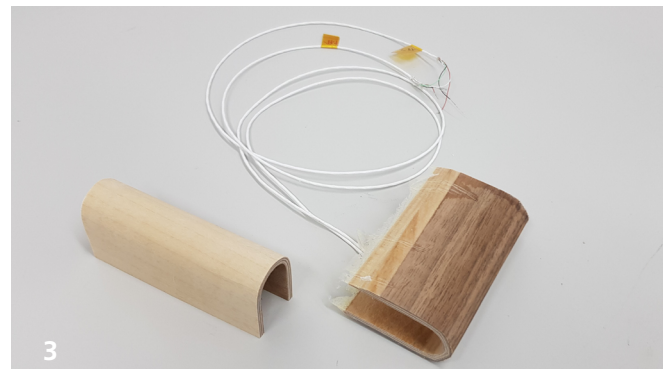
Umgeformtes Furnier mit Sensorintegration.
