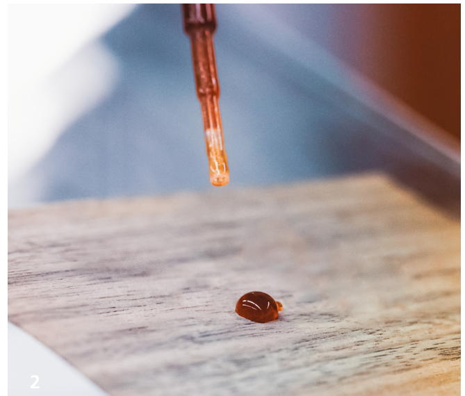
Nachhaltig mittels Atmosphärendruck-Plasmaverfahren beschichtetes Furnier.
