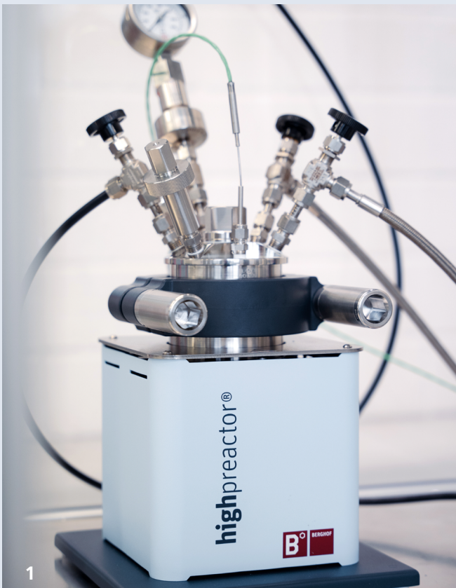
Deuteriumreaktor zur kontrollierten Beladung von Proben mit Wasserstoff oder Deuteriumgas mit Drücken bis 200 bar und Temperaturen bis 300 °C.
