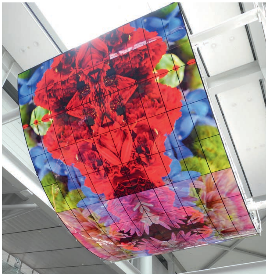
Bild 9 > Das OLED-Display erlaubt die Realisierung von flexiblen Großbildschirmen.
