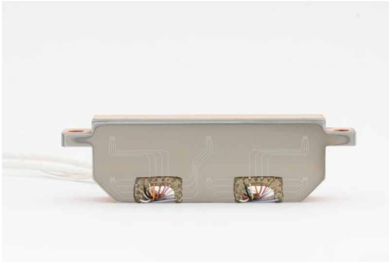
Abb. 1 Sensorischer Hochstrom-Kontaktpartner mit sechs Dünnschichtsensoren zur Temperaturmessung. © Fraunhofer IST
