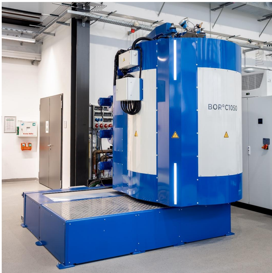
Abb. 1 Die neue Gasborieranlage am Fraunhofer IST erzeugt durch Diffusionsbehandlungen bei bis zu 1050°C boridische Randzonen mit außergewöhnlichen technologischen Eigenschaften.
