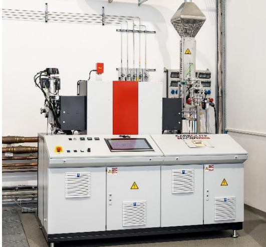
Abb. 2 Der seit neuestem verfügbare Hochtemperaturofen erlaubt Untersuchungen im Temperaturbereich von bis 1600 °C. © Fraunhofer IST
