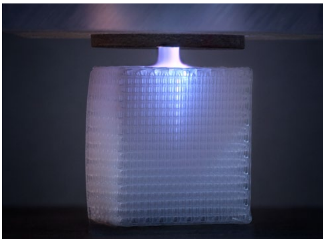
Beschichtung von Gerüststrukturen für Implantate mit einem Plasmajet.
